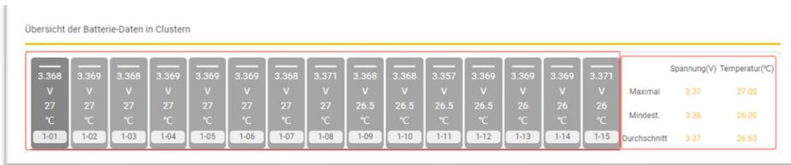
Abb. 10-4. Darstellung der konkreten Daten von einem Batterie-Cluster.
